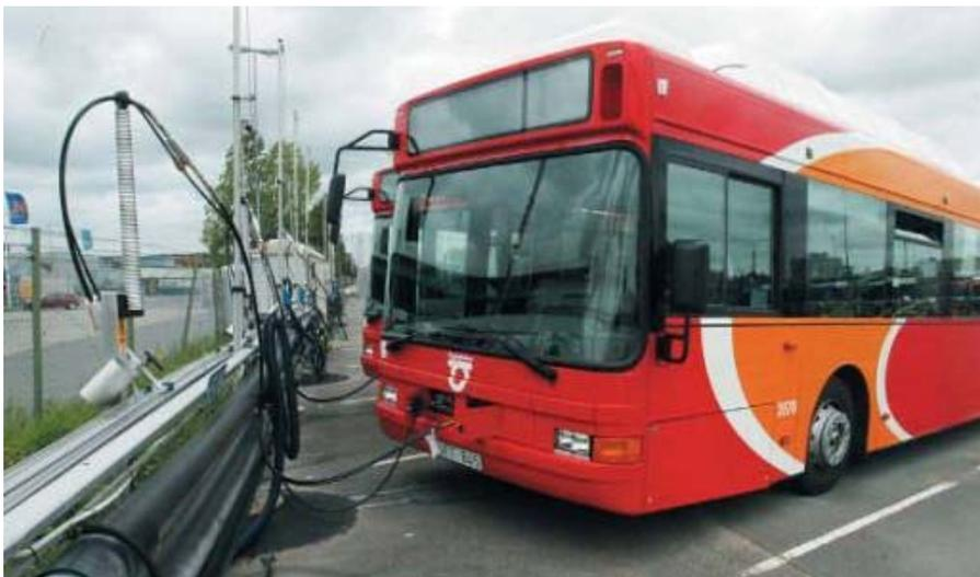
Abbildung 3-17: Biogas-Bustankstelle in Norrköping, Schweden /79/
